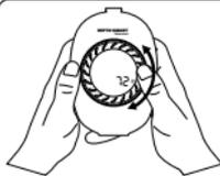
Tournez le bouton principal dans le sens des aiguilles d'une montre ou dans le sens inverse pour alterner entre °C ou °F.
