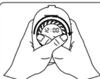
Ruotare la manopola principale di 180° in senso orario tenendo premuta la manopola principale.
