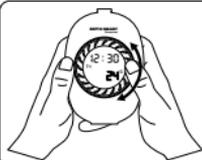
Tournez le bouton principal dans le sens des aiguilles d'une montre ou dans le sens inverse pour augmenter ou diminuer la température. (20°C à 50°C).
