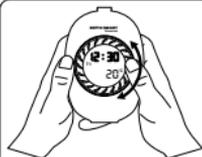
Ruotare la manopola principale in senso orario o antiorario per aumentare o diminuire l'ora di 30 minuti (da 00:00 a 23:30).
