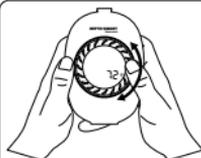
Ruotare la manopola principale in senso orario o antiorario per passare da °C a °F.
