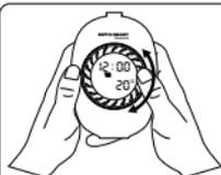
Tournez le bouton principal dans le sens des aiguilles d'une montre ou dans le sens inverse pour passer de T1 à T8.
