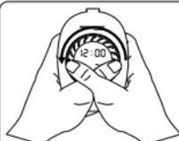
Drehen Sie die Haupttaste 180° gegen den Uhrzeigersinn, während Sie die Haupttaste gedrückt halten.
