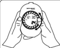
Drehen Sie den Hauptknopf im oder gegen den Uhrzeigersinn, um die Temperatur zu erhöhen oder zu verringern. (20°C bis 50°C).
