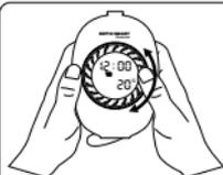
Ruotare la manopola principale in senso orario o antiorario per passare da T1 a T8.
