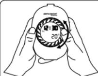
Drehen Sie den Hauptknopf im oder gegen den Uhrzeigersinn, um die Zeit um 30 Minuten zu erhöhen oder zu verringern. (00:00 bis 23:30).
