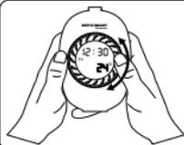
Ruotare la manopola principale in senso orario o antiorario per aumentare o diminuire la temperatura. (da 20°C a 50°C).
